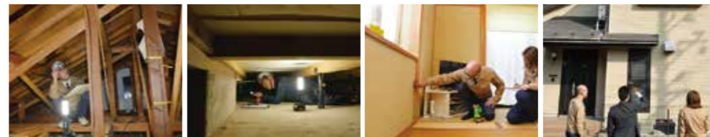
小屋裏検査 床下検査 傾き検査(レーザー水平器使用) 外壁等診断
